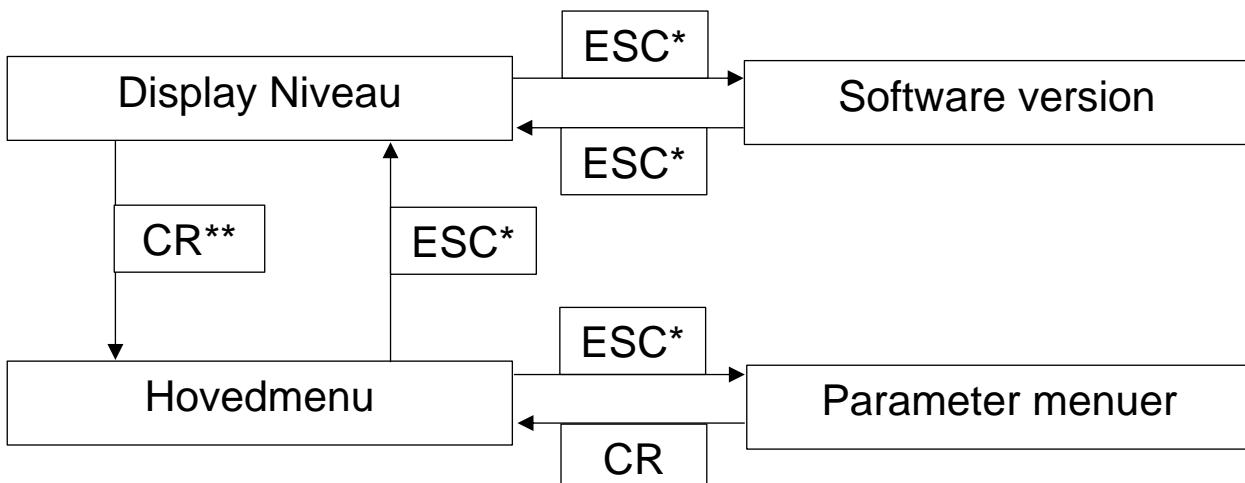
1. \*Generelt, hvis der ikke trykkes på en tast i 10 minutter, vil BWT ledningsevnemåleren gå til Display Niveauet.
