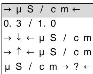
7. Wählen Sie C-Konstante entsprechend dem ausgewählten Leitfähigkeitssensor, indem Sie die hervorgehobene Menüoption wie unten gezeigt auswählen. Wählen Sie mit den Pfeiltasten C-Konstante und bestätigen Sie mit "CR". Der richtige Sensor (C-Konstante 0,3 / 1,0) muss mit dem relevanten Bereich verwendet werden.
