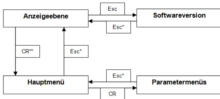
\* Generell erfolgt nach 10 Minuten ohne Tastenbetätigung ein Rücksprung in die Anzeigeebene.
