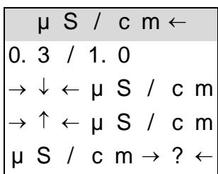
7. Vælg Celle-konstant i overenstemmelse med den påmonterede ledningsevne-sensor. Brug piletasterne til at vælge den ønskede celle-konstant og bekræft med "CR".
