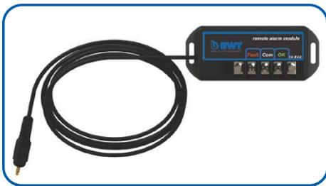
Über ein Kontaktpaar kann eine Verbindung zu einem Remote-Gerät hergestellt werden (z. B. Summer, Leuchte, Alarmsystem, SPS usw.). Im normalen Betrieb werden die OK- und COM-Kontakte angeschlossen. Bei Vorliegen einer Störung (geringe UV, Lampenstörung, Netzstörung) werden die Fehler- und COM-Kontakte verbunden. Die maximale Kontaktleistung beträgt 1 A-120 V AC/DC (16-22 AWG verwenden).
