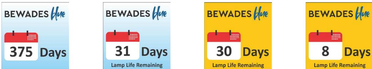
Wenn 30 Tage verbleiben, wird im Bildschirm des Displays eine gelbe Warnleuchte angezeigt. Wenn 7 Tage verbleiben, gibt die UV-Anlage zusätzlich ein Warnsignal aus. Wenn der Grenzwert „null Tage“ überschritten wurde, wird der Bildschirm durchgehend rot angezeigt und ein durchgehender Signalton wird ausgegeben.
