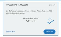
Zur Ermittlung der Wasserhärte sollte die Wasserprobe an der nächstgelegenen Entnahmestelle bei einem Volumenstrom von 400-600 I/h entnommen werden
