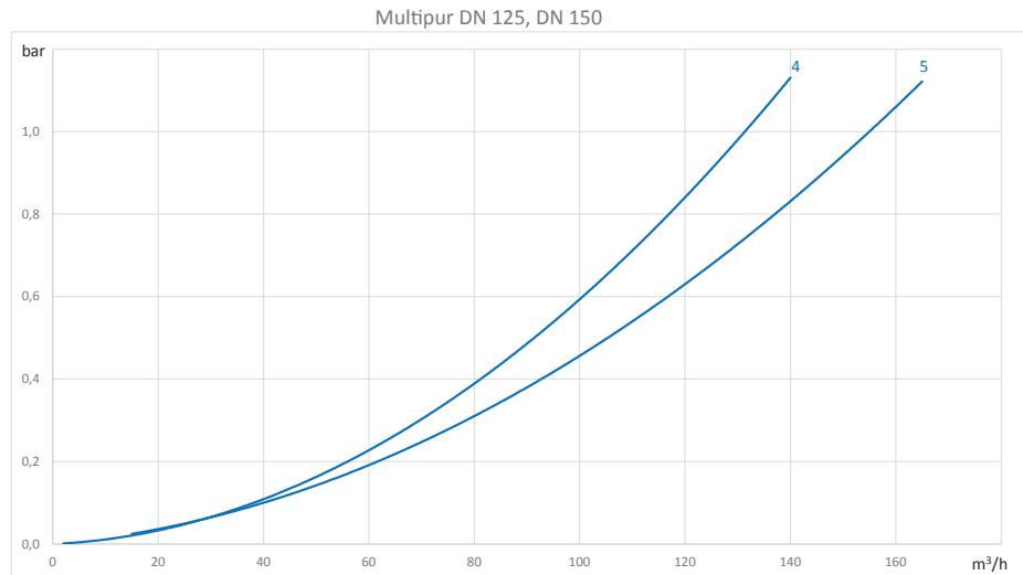
1 = Multipur DN 65 // 2 = Multipur DN 80 // 3 = Multipur DN 100 // 4 = Multipur DN 125 // 5 = Multipur DN 150
