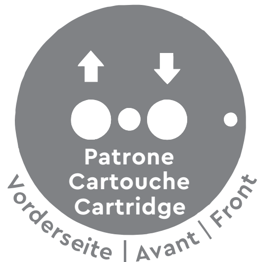
Abb. 18: Montagerichtung Steuerkopf auf Patrone
