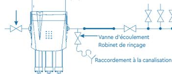
6.10. Fermer le robinet de rinçage et ouvrir tous les robinets d'arrêt du distributeur AQA total
