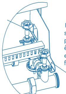
Pour assurer un montage sans tension, la distance par rapport au mur peut être légèrement modifiée en desserrant les vis de fixation pré-montées.
