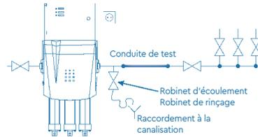
Outre la conduite témoin, un point de prise d'eau doit être prévu en aval de l'appareil AQA total. Ce robinet d'écoulement sert de robinet de rinçage et de point de prélèvement d'eau potable. Il doit avoir un diamètre nominal de DN 15 au minimum.
