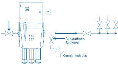
6.10. Spülventil schließen und alle Absperrventile des AQA total Energy Verteilers öffnen.
