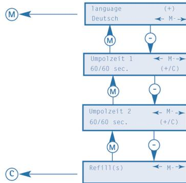
Nach dem Refill Tausch (im Normalfall alle) muss dies der elektronischen Steuerung bestätigt werden.
