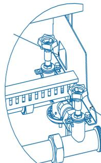
Per eseguire un montaggio privo di tensione, è possibile variare la distanza dalla parete in un determinato punto allentando le viti di fissaggio premontate.
