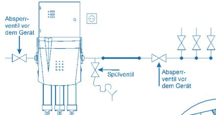
6.2. Sofern die Anlage mit einer Umgehungsleitung ausgeführt ist, kann diese während der Inbetriebnahme geöffnet werden, um die Wasserversorgung zu gewährleisten. Achtung – bei geöffneter Umgehungsleitung gelangt unbehandeltes Wasser in das Rohrleitungssystem.
