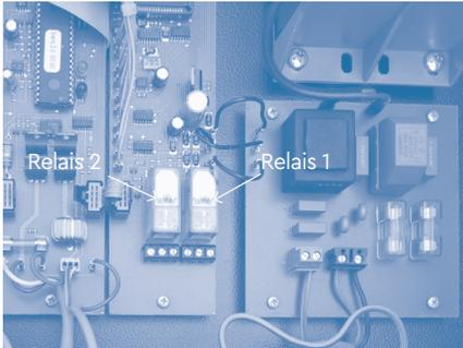
Die ZLT Relais fallen bei Ausgabe eines Signals und bei Stromausfall ab.
