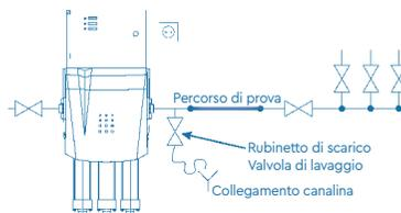
Oltre al percorso di prova, dopo l'apparecchio AQA total deve essere predisposto un punto di prelievo dell'acqua. Questa valvola di scarico funge da valvola di lavaggio e come punto di prelievo dell'acqua potabile e deve presentare una larghezza nominale minima di DN 15.
