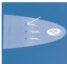
Le voyant jaune « POWER » (sur le boîtier de commande) s'allume pour indiquer que l'appareil est alimenté électriquement.
