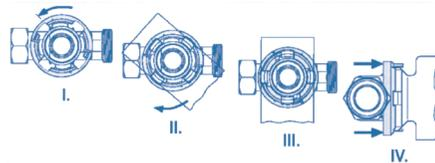
Zum Lösen der Verdrehesicherung den Sicherungsring an den beiden Laschen zusammendrücken und mit beiden Händen nach oben drücken.
