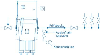
Dieses Auslaufventil dient als Spülventil und als Trinkwasserentnahmestelle und muss eine Mindestnennweite von DN 15 aufweisen.
