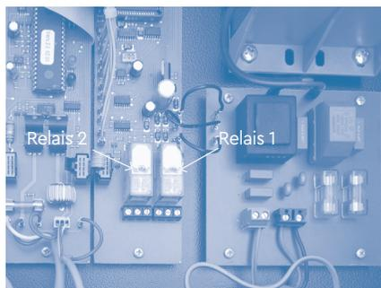
Les relais ZLT se déclenchent en cas d'émission d'un signal ou de coupure de courant.
