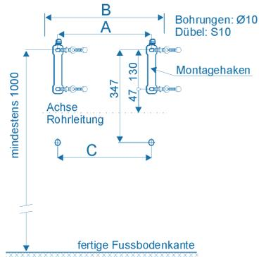
5.5.3. AQA total Energy Anschlussverteiler laut Abbildung in Montagehaken einhängen und mit den beigelegten Schrauben fixieren.
