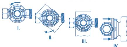
Pour débloquer la rotation, appuyez sur les deux pattes de la bague de sécurité et la repoussez à deux mains vers le haut.
