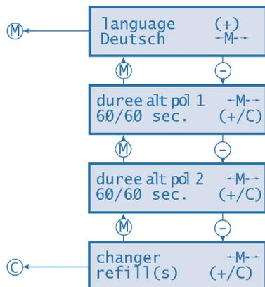
Bien que les recharges doivent être remplacées toutes à la fois, il est possible de valider le remplacement d'une seule unité à la fois. Le remplacement d'une seul unité doit être validé de la manière suivante.
