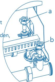
a) Absperrventil des AQA total Energy Verteilers
