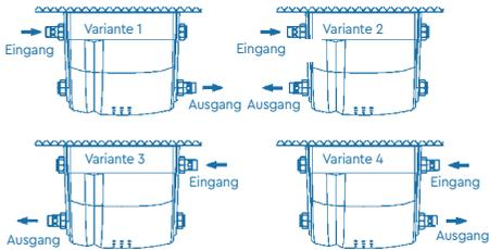
Der Wassereingang muss immer auf der hinteren Seite des Gerätes erfolgen. Beachten Sie den „IN“ Aufkleber auf dem AQA total Energy Anschlussverteiler.
