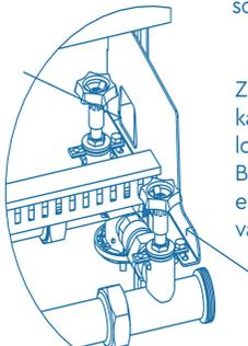
Zur spannungsfreien Montage kann der Wandabstand durch lockern der vormontierten Befestigungsschrauben in einem gewissen Bereich variiert werden.
