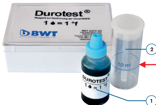
Abb. 28: Test-Set für Speisewasserhärte
