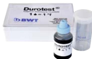
Pour connaître la dureté de l'eau disponible, on applique le mode d'emploi du test de dureté „DU-ROTEST“ (réf. 112438) fourni. Remplissez l'éprouvette fournie de 10 ml de l'eau à évaluer et faites-y tomber – en les comptant – des gouttes de la solution d'essai jusqu'à constater que le liquide initialement rouge tourne
