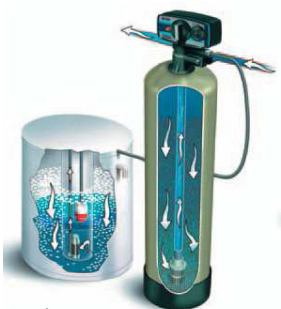
2. ábra Egyoszlopos készülék működési vázlata
