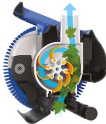
V-Flex turbine met bewegende bladen voor het opzuigen van grove vuilresten
