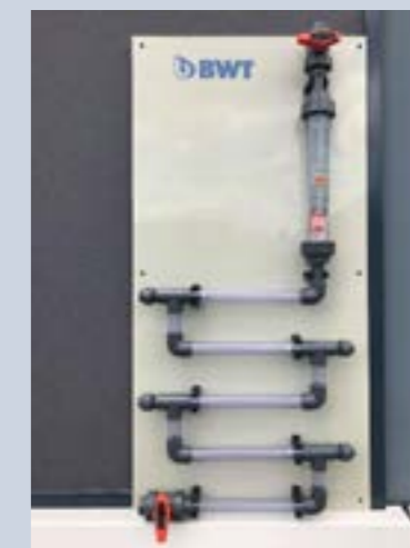
Pvc-corrosierek op paneel, met isolatiekleppen, rotameter en transparante secties
