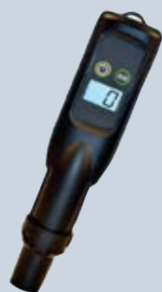
Koelcircuits Draagbare fluorescentiemeting
