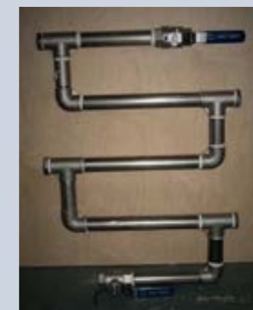
Roestvrijstaal corrosierek, met isolatiekleppen
