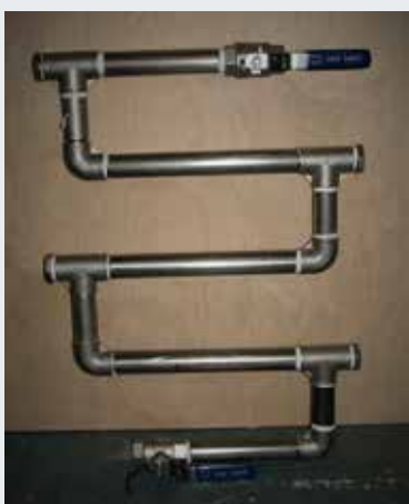
Roestvrijstalen corrosierek, met isolatiekleppen
