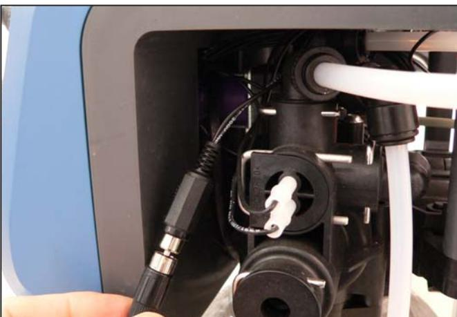
De aansluitkabel met de stekkers op het regelventiel aansluiten.
