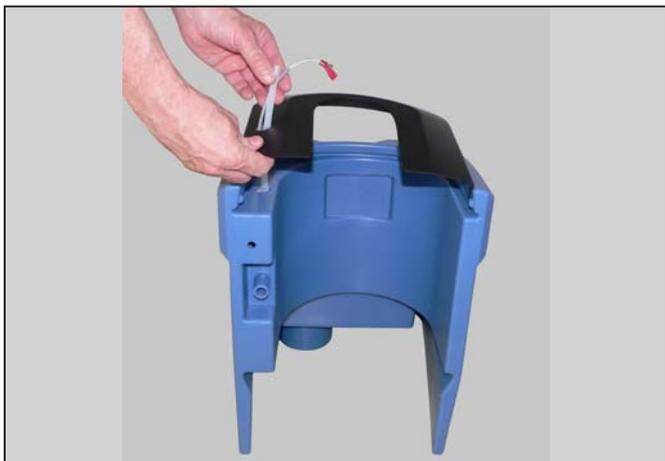
Faites passer le tuyau de saumure et le câble de raccordement par le trou de perçage dans le couvercle noir.
