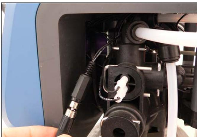
Reliez le câble de raccordement à la vanne de réglage au moyen des connecteurs.
