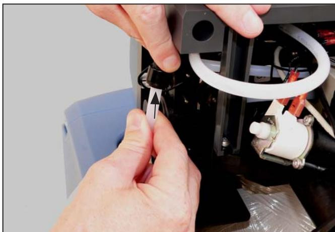
Enfoncez le tuyau de saumure jusqu'à la butée (à env. 15 mm de profondeur) dans le raccord coudé prévu pour le tuyau.
