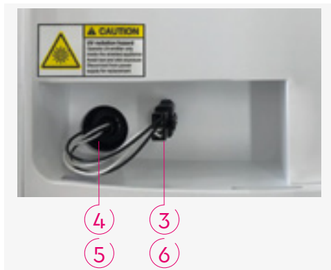
Rys. 12: Wnęka lampy UV pod pokrywą urządzenia AQA drink Pro 20
