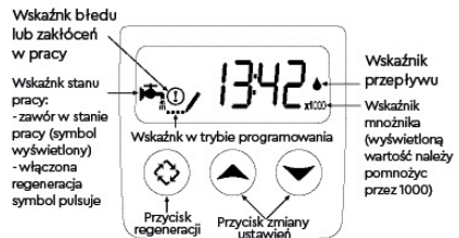
PANEL KONTROLNY STEROWNIKA
